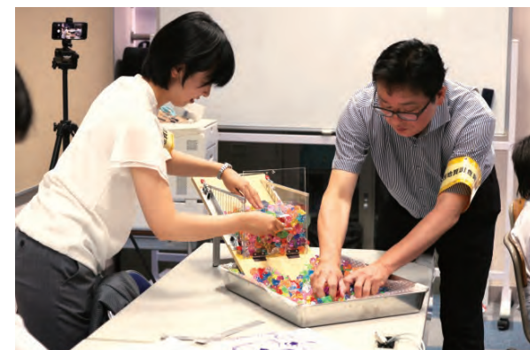
写真-7 補強土工の実験装置
