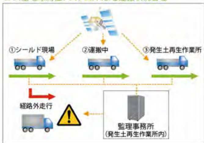
図-3 GPS運搬状況管理
