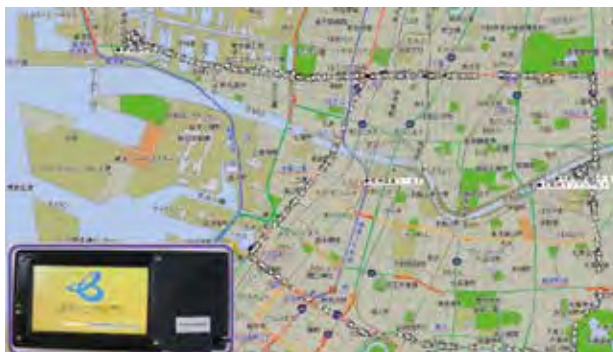
写真-2 GPS運搬状況管理画面とGPS車載器
