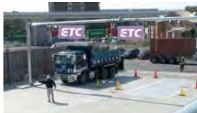
写真-1 ETC車両認証 (発生土再生作業所)
