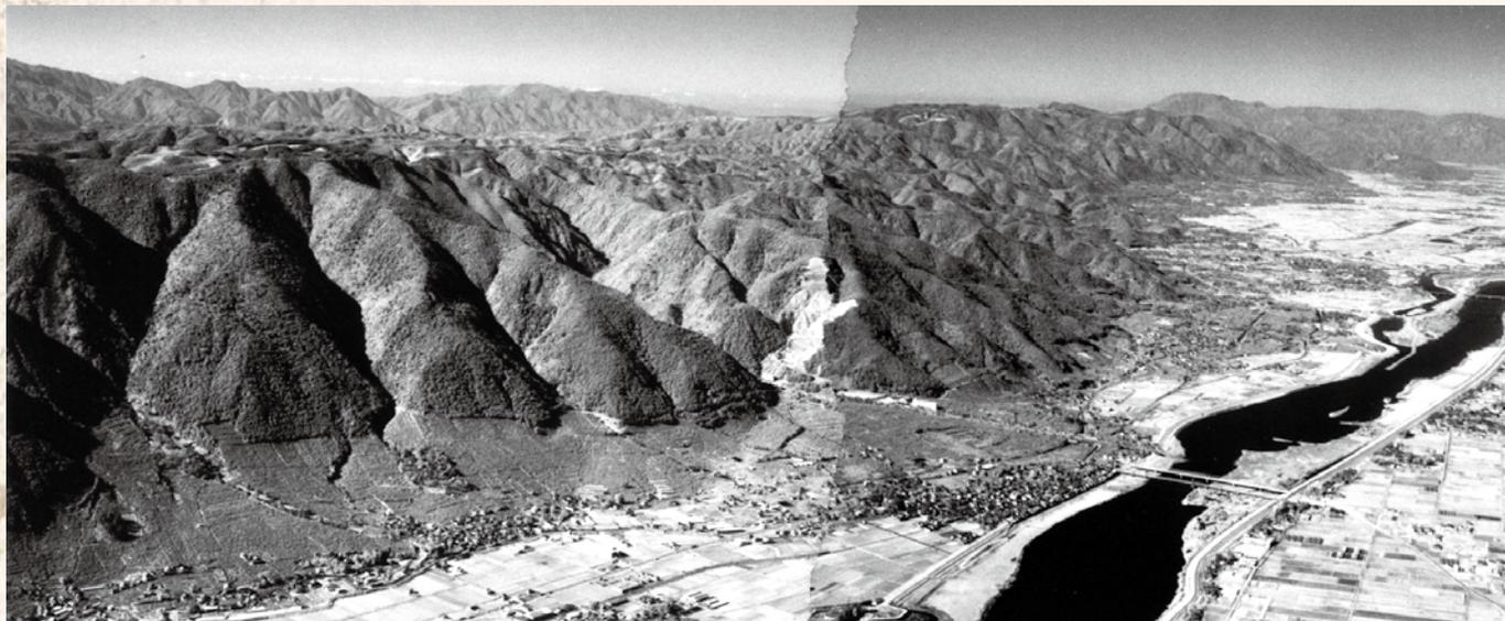
写真-1 養老断層崖と濃尾平野西部 写真中央の急斜面は養老断層崖。その下部の扇状地末端部付近を養老断層が通過し、長く延長する。地下では大きな変位量となり、地質構造も大きく異なる。北西方向を望む(1979年岡田撮影)
