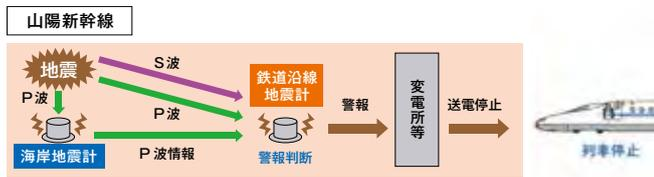
図-2 早期地震検知警報システムの概要
