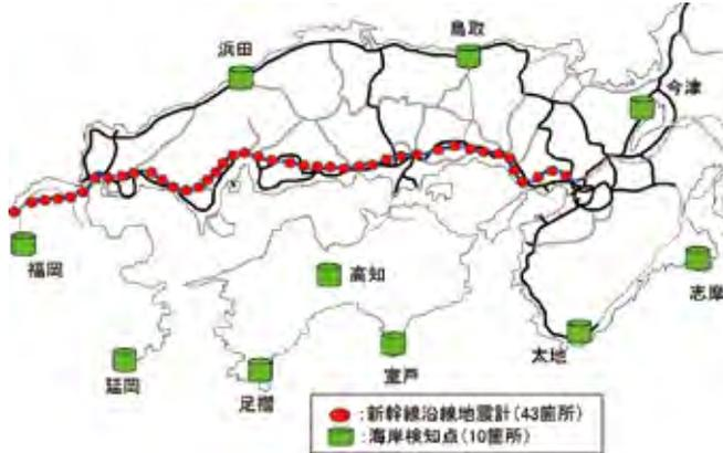
図-1 新幹線早期地震検知の取り組み
