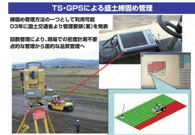
図-3 TS・GPSによる盛土締め管理
