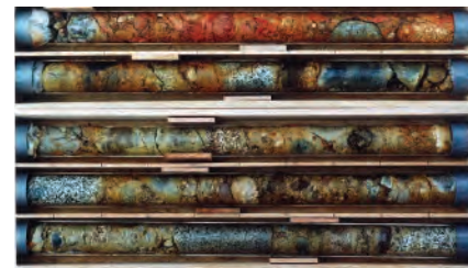
記憶に残るコア、「この砂礫層のコア採取の成功から、弊社の高品質ボーリングはスタートしました。」 ハイテック(株)
