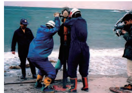
ロシア船ナホトカ号重油流出事故よりはや10年。簡易ボーリングマシン(SCSC)による重油流出汚染土壌試料採取状況。 (株)サンケン試錐コンサルタン
