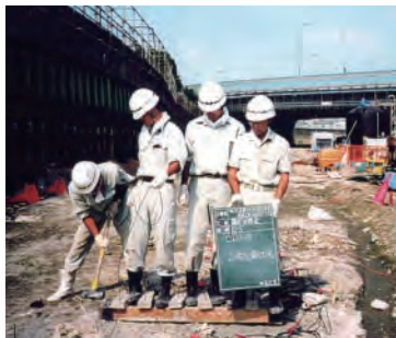
市内正蓮寺川河床部での地盤改良効果判定のため、S波浅層反射法を実施した。炎天下の板叩き作業が心に残ります。 日本物理探査(株)
