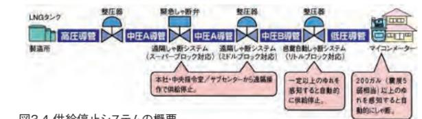
図3.4 供給停止システムの概要
