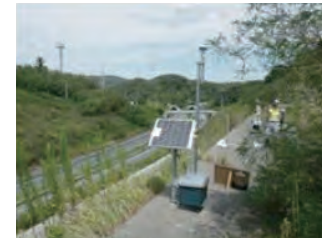
写真-3 RTK-GNSSによる計測状況
