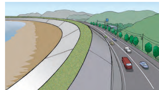
図-2 ハード対策（海岸堤防）の模式図
