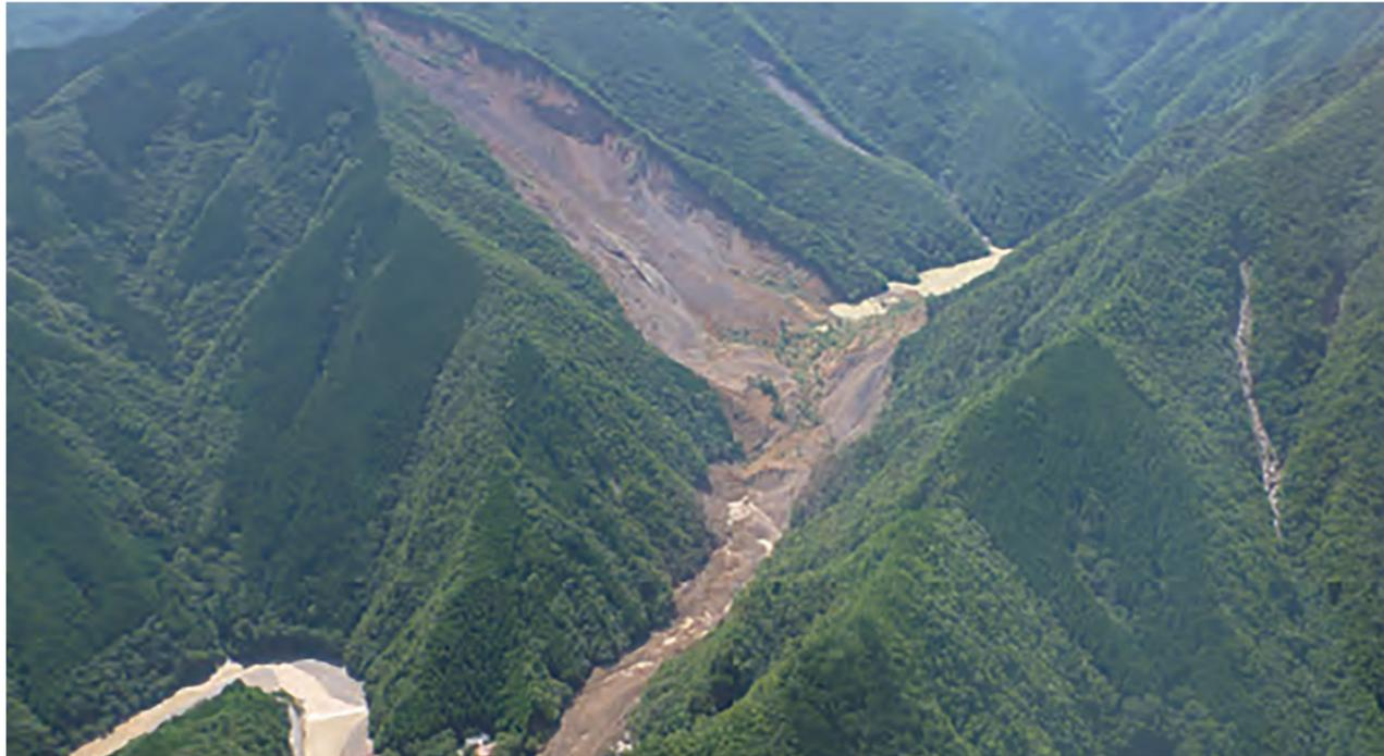
奈良県十津川村赤谷では大規模な斜面崩壊が発生し、河道が閉塞した
