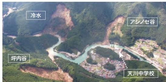
奈良県天川村では3地区の大規模崩壊が発生し、天ノ川閉塞による浸水被害が発生した。
