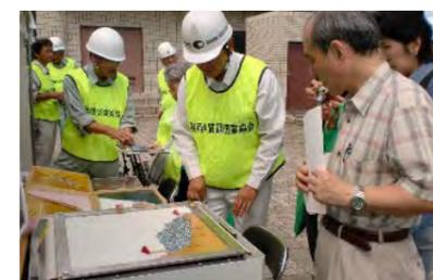
斜面崩壊模擬モデルによる実験
