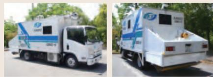
写真-4 空洞調査に加えて路面点検も同時調査できる探査車両 (航測システムと同等の三次元点群測量システム配備)
