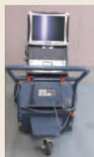
写真-2 手押し式探査装置 (アンテナ周波数400MHz)
