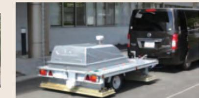
写真-6 地下3m以上を調査できる探査車両 (チャープ方式+アンテナの大型化)
