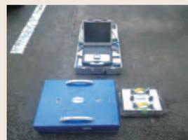
写真-1 アンテナ分離方式の探査装置 (左アンテナは周波数400MHz、右アンテナは周波数800MHz)
