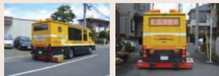
写真-3 一般的な路面下空洞探査車両 (調査幅2.5m程度、時速40km以上で走行計測可能)
