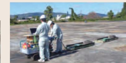
写真-5 地下5m以上を探査できる装置 (FMCW方式+アンテナの大型化)
